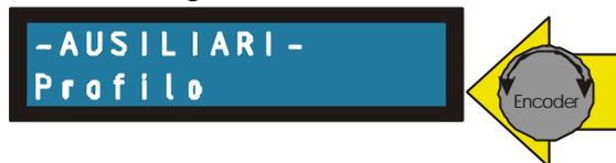
Ruotando l'encoder si scorrono i sottomenù: *Profilo, Lingua, Test Saldatura, Alimentazione, Test SCR, ecc.* Premendo il tasto Enter (integrato nell'encoder) si entra nei sottomenù.
