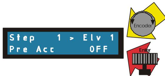
*Ad ogni step impostato è possibile associare lo stato (ON/OFF) delle quattro elettrovalvole.*
