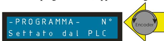
Con questa impostazione, posizionando il selettore a chiave in modalità saldatura, è possibile richiamare dall'esterno i programmi da 0 a 15.
