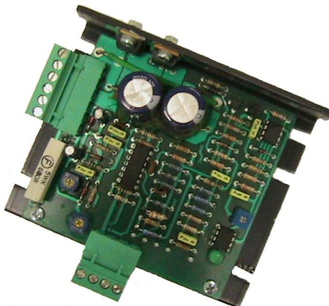
Re232 è un azionamento monodirezionale a transistor che permette la regolazione della velocità in motori a corrente continua.
