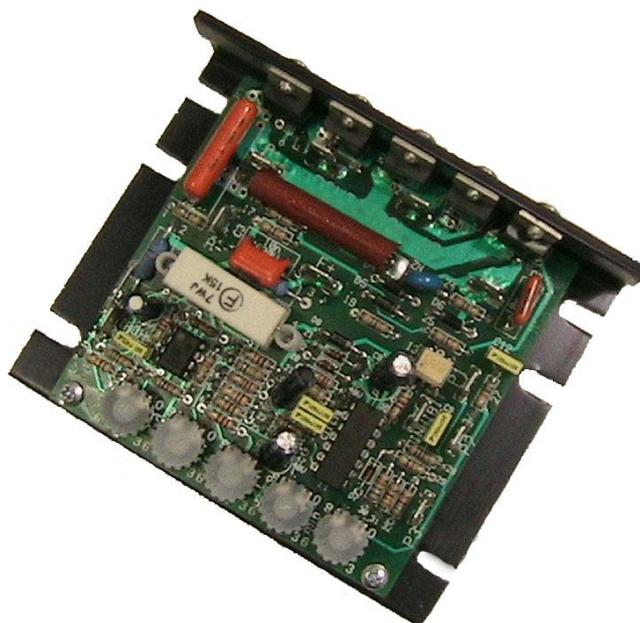
1Q è un azionamento che consente la regolazione di velocità di motori a corrente continua, con impostazione del riferimento da potenziometro esterno. Esso dispone delle seguenti regolazioni (tramite trimmers a bordo scheda) :
